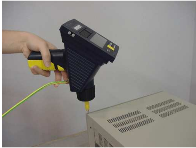
図 16: 被試験装置への ESD の印加
